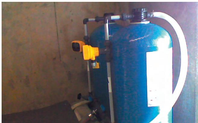
Fotografia 6.3.1.2 – Filtro piloto instalado na ETA da Póvoa para ensaios de diversos tipos de carvão activado e sua eficiência na remoção de cianobactérias
