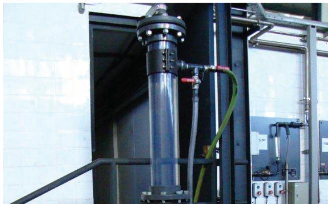
Foto 8.2.1.4.1 – Sistema-piloto de filtração na ETA do Caia
