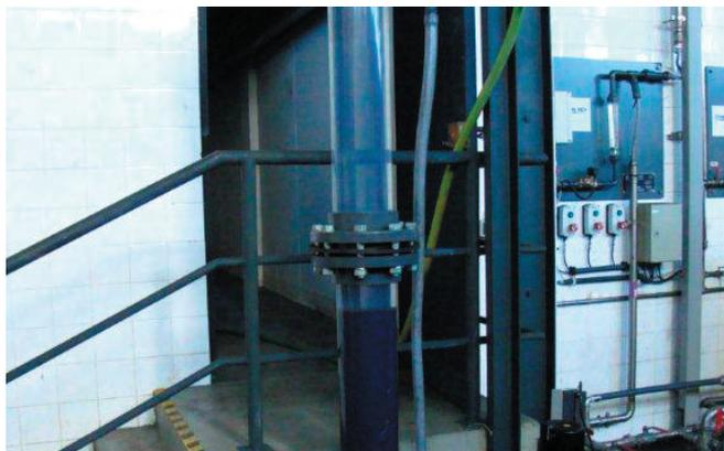
Fotografia 6.2.1.1 – Filtro piloto instalado na ETA do Caia para ensaios de diversos tipos de enchimento
