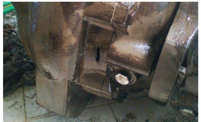
Fotos 8.2.2.8.2 – Desgaste apresentado pelas bombas da EE de Avis, devido a presença de areias no afluente
